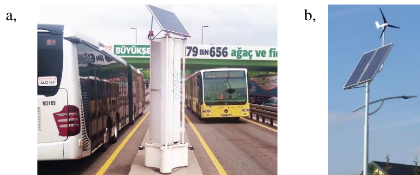
7. ábra. Városi környezetben található szélturbinák. a, Közlekedés menetszelét hasznosító függőleges tengelyű szélturbina [31]; b, Lámpaoszlopra szerelt napelem és szélturbina [32]
