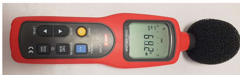
42. ábra: Alkalmazott UT352 digitális zajszintmérő műszer, forrás: saját
