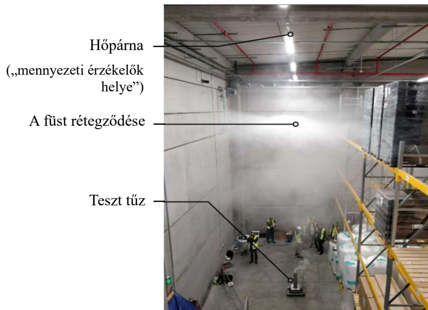
22. ábra: Hőpárna-hatás és füst rétegződés jelensége, Forrás: [34]
