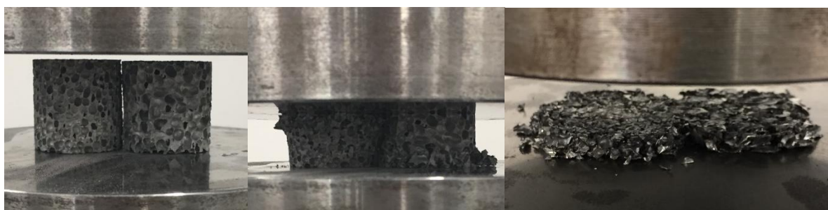
41. ábra Párhuzamos elrendezés zömítésének folyamata [KJ120]
