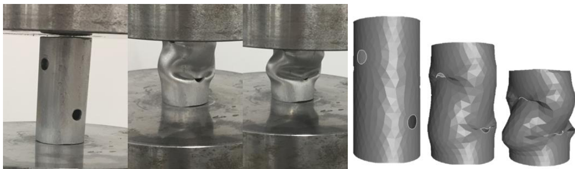
52. ábra A választott anyagmodell és a paraméterezési folyamat validálása [KJ118]
