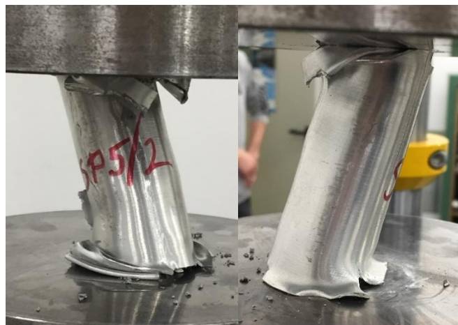
90. ábra Az 2.sz. konstrukció zömítése során jelentkező kihajlási probléma
