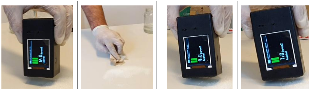
63. ábra: A „mért” virtuális felületi szennyezettség értékek csökkenése a dekontaminálási fázisokat követően
