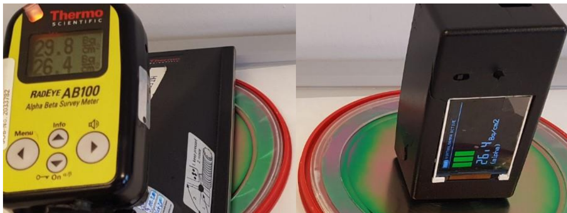
62. ábra: A valósi (bal oldali ábra) vs. virtuális felületi szennyezettség mérő (jobb oldali ábra) „mért” alfa felületi szennyezettség értéke (valós mérőeszköznél az alsó érték) a második etalon forrás esetén, mindkét esetben 26,4 \text{ Bq/cm}^2
