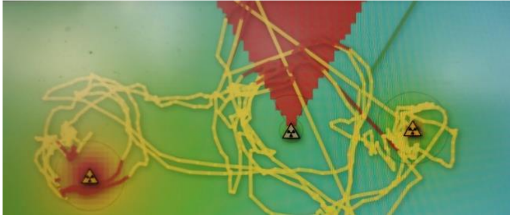
61. ábra: Az aktuális dózistérkép megjelenítve, feltüntetve a forrásokat és a felderítő útvonalát
