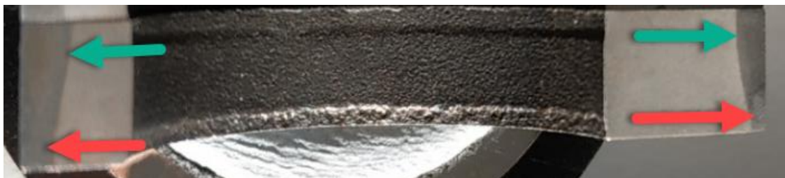
11.ábra. Nem-megfelelő edzési profil (forrás: saját szerk.)
