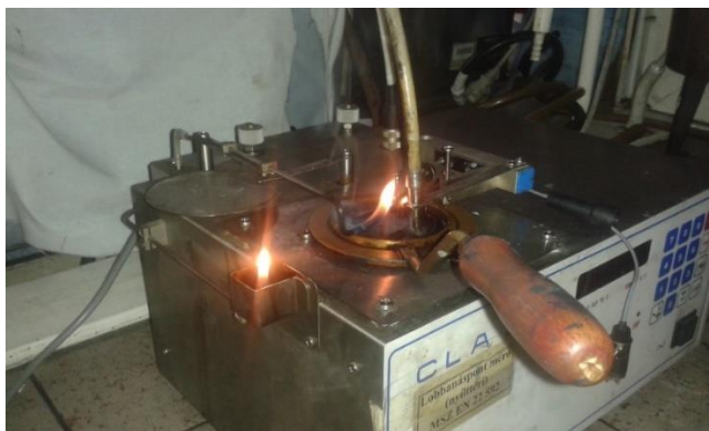
3. ábra: Lobbanáspont mérés CLA 2 típusú készülékkel (saját kép)
