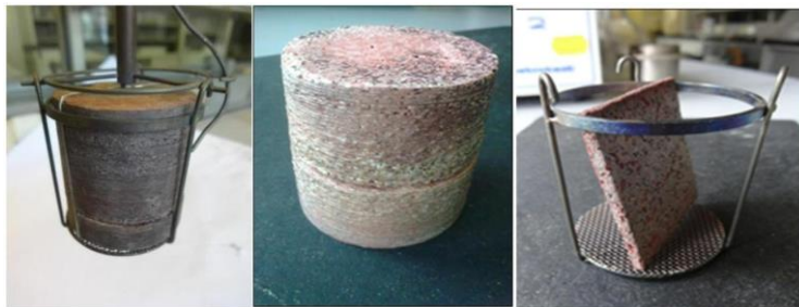
1. ábra: Neméghetősségi vizsgálat kompozit anyagból készült a standard vizsgálati és a valós méretű mintán (saját kép)
