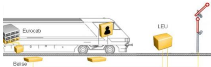
1. ábra. Az 1-es szintű ETCS csak pontszerű vonatvezérlést valósít meg [23]
