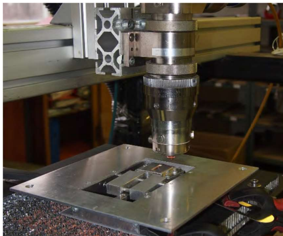
24. ábra A mérőhasábbal állítható fóliafeszítő a lézerfej alatt.
