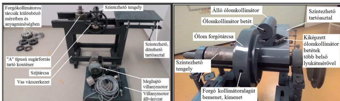
72. ábra: A referencia pulzált teret előállítani képes Gamma-chopper berendezés [20]
