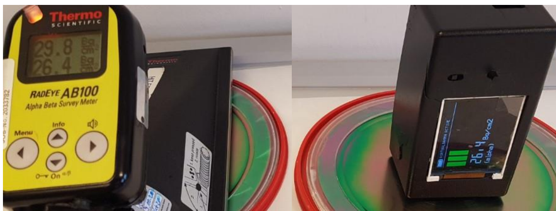
65. ábra: A valós (bal oldali ábra) vs. virtuális felületi szennyezettség mérő (jobb oldali ábra) „mért” alfa felületi szennyezettség értéke (valós mérőeszköznel az alsó érték) a második etalon forrás esetén, mindkét esetben 26,4 \text{ Bq}/\text{cm}^2
