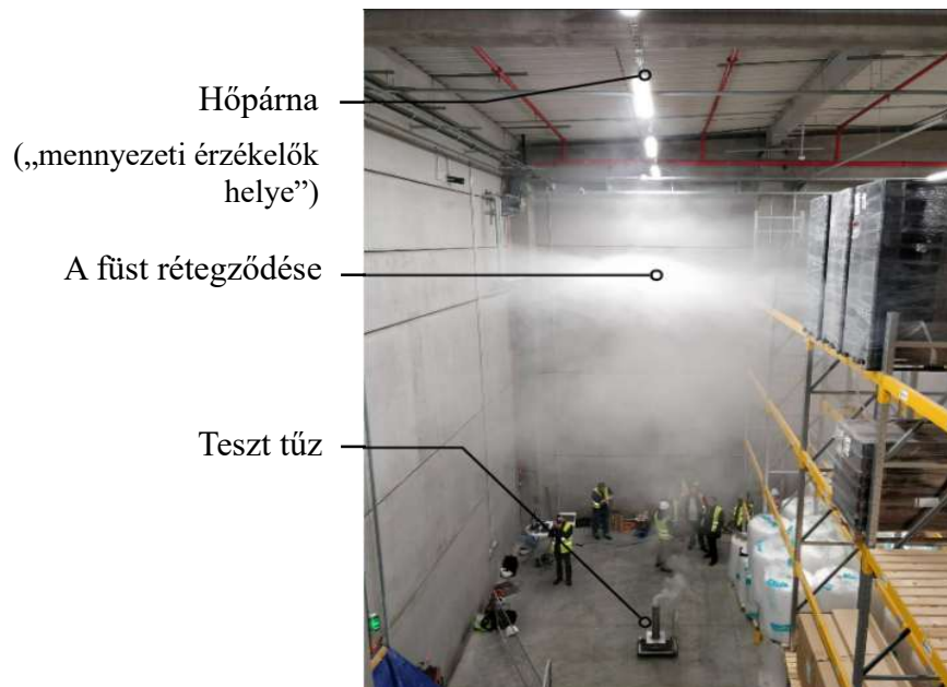
21. ábra: Hőpárna-hatás és füst rétegződés jelensége, Forrás: [34]
