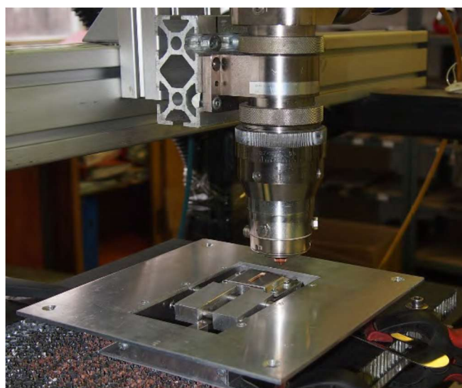
30. ábra A mérőhasábbal állítható fóliarögzítő a lézerfej alatt
