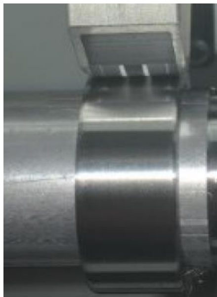
17. ábra: Stresstech mérőgép működés közben, vizsgált anyag R_z értéke: \sim 1,5\text{ }\mu\text{m}
