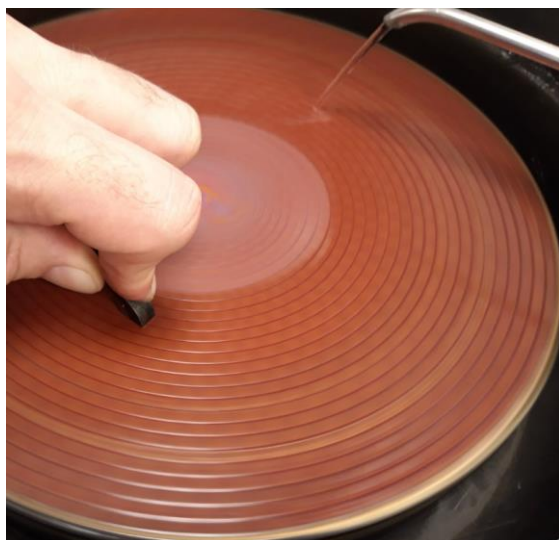
6.ábra. Csiszolás művelete közben (forrás: saját szerk.)
