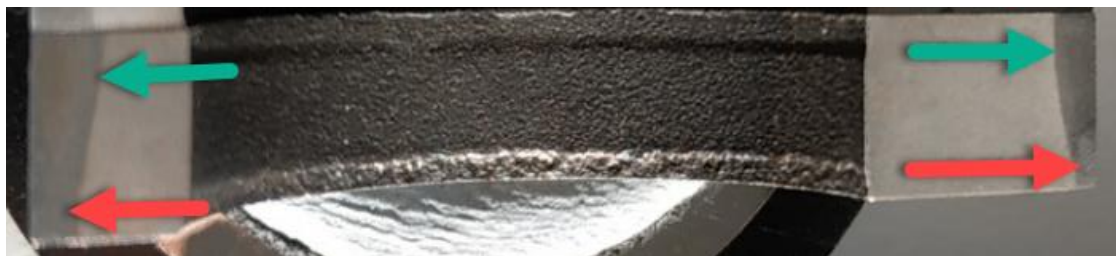
10.ábra. Nem-megfelelő edzési profil (forrás: saját szerk.)
