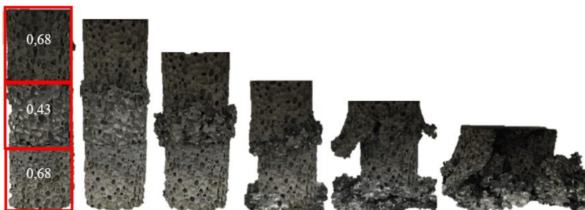
49. ábra A háromtagú soros elrendezés zömülése képekben
