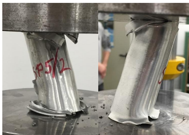
92. ábra Az 2.sz. konstrukció zömítése során jelentkező kihajlási probléma
