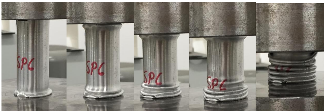
95. ábra A fémhabbal töltött szelvény (SP6) zömülésének folyamata
