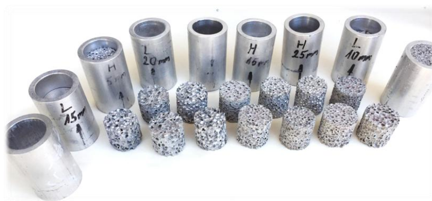
14. ábra A sűrűlási ellenállás meghatározásához használt próbadarabok [KJ118]
