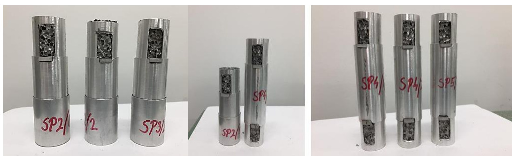
83. ábra A próbadarabok a zömítő vizsgálatok előtt
