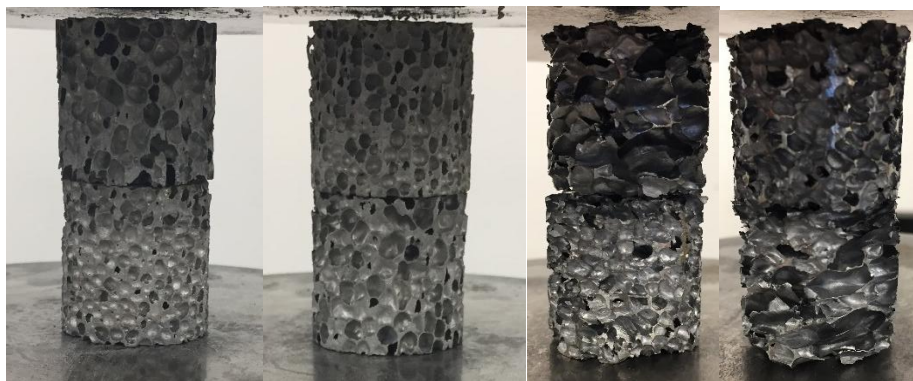
44. ábra A vizsgálatához használt fémhab próbatestek a zömítés előtt [KJ123]
