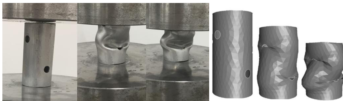
53. ábra A választott anyagmodell és a paraméterezési folyamat validálása [KJ121]
