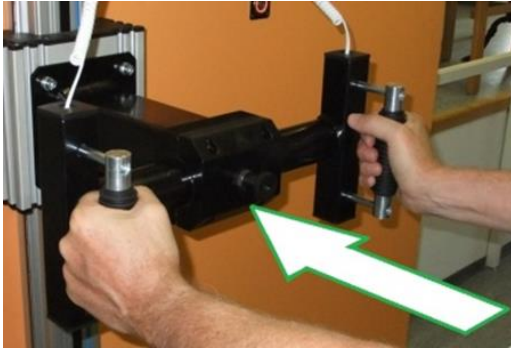
0. panel Statikus nyomás vízszintesen két kézzel [43]
