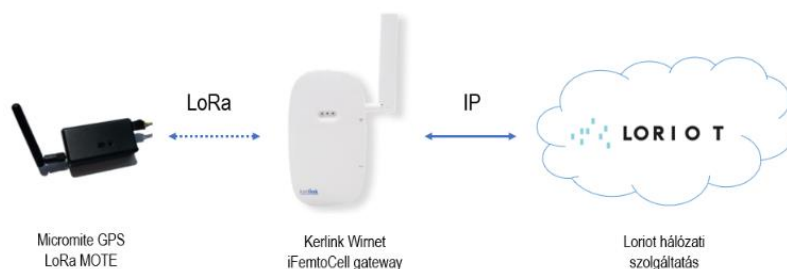
5. ábra – Budapesten végzett lefedettségvizsgálat mérési összeállítása (Készítette a szerző: [9])
