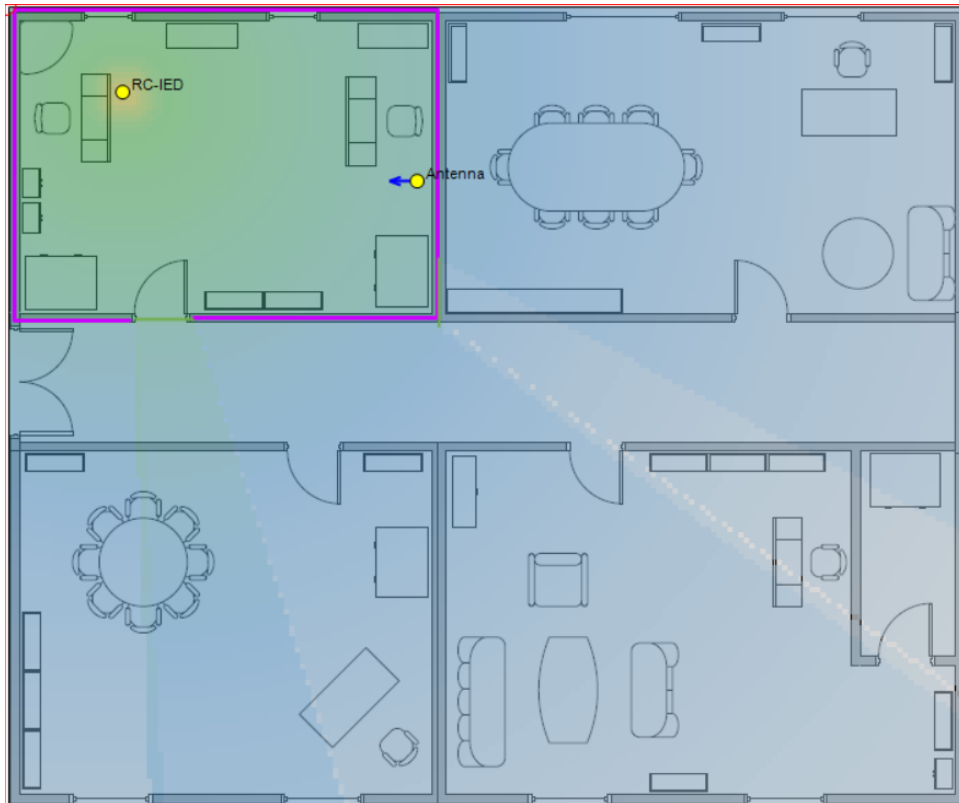
24. ábra RC-IED RF-sugárzása 422MHz-es frekvencián tesztkörnyezetben szimulálva
