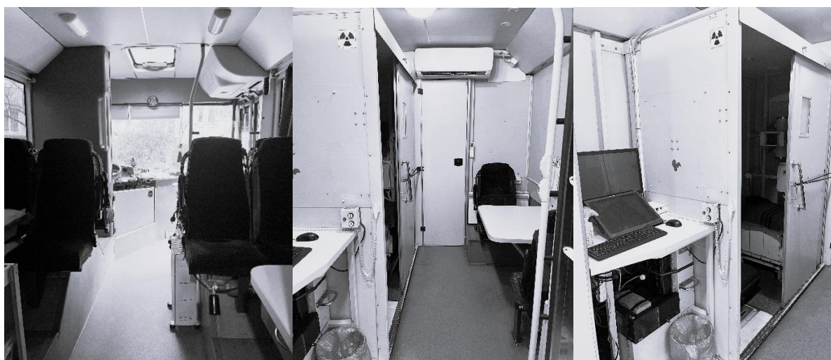
Az Ikarusz busz belsőjében kialakított röntgen állomás
