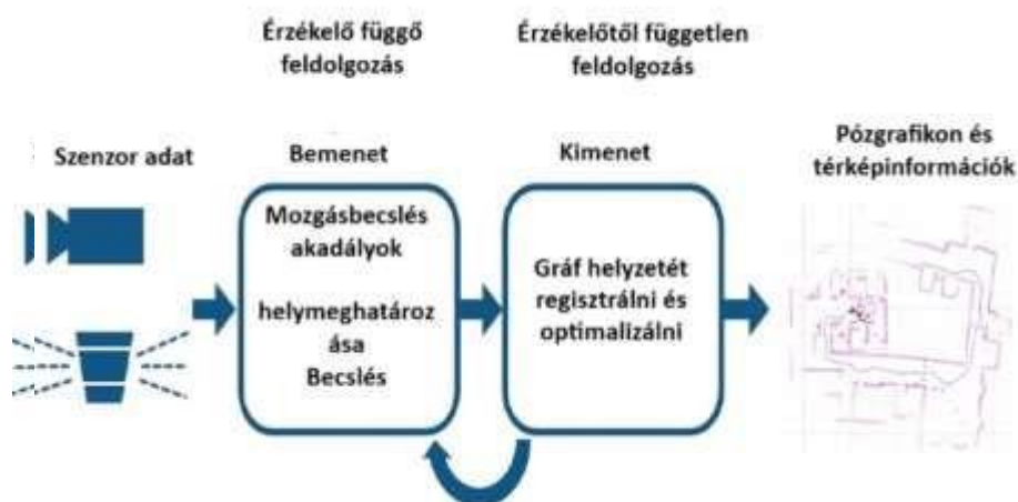
9. ábra Szenzor működése Forrás: [108]
