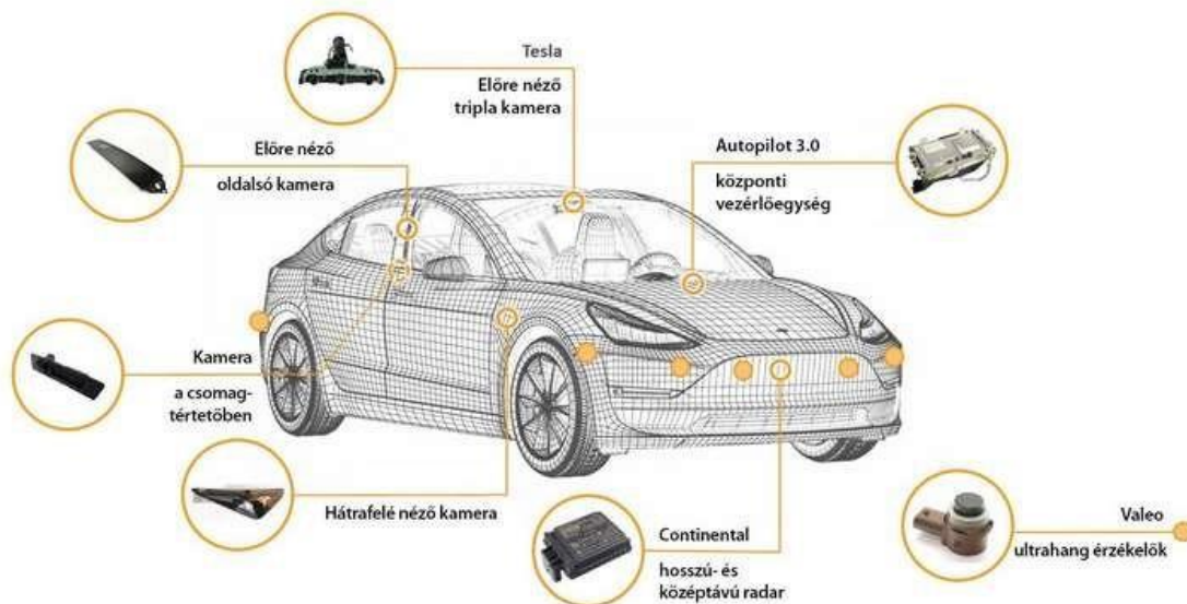
7. ábra Önvezető autók érzékelői Forrás: [108]
