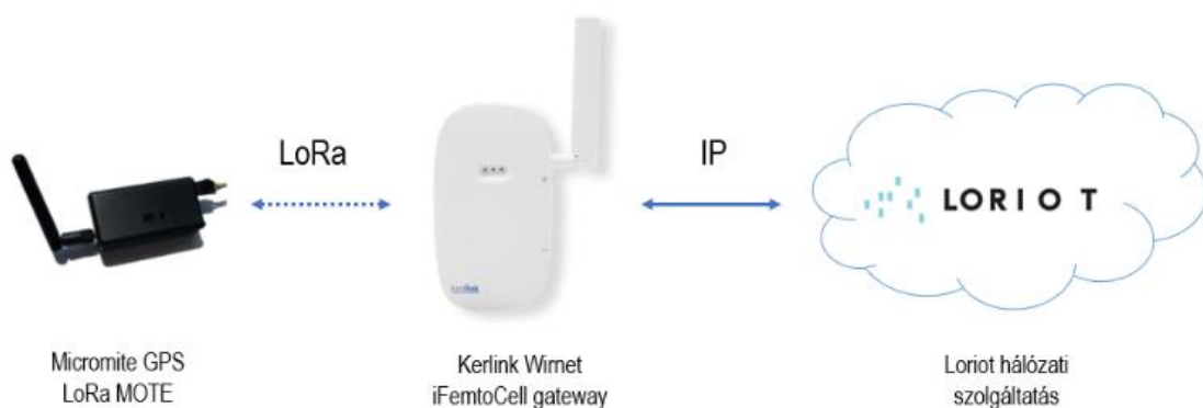
5. ábra – Budapesten végzett lefedettségvizsgálat mérési összeállítása (Készítette a szerző: [9])
